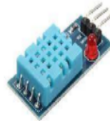
Capteur de température et d'humidité DHT11
